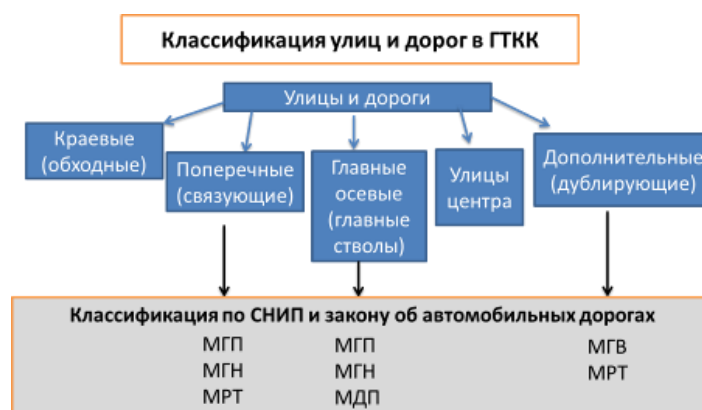
Рисунок 8 - Идея классификации улиц и дорог в ГТКК: МГП – магистраль общегородского значения первого класса; МГВ – магистраль общегородского значения второго класса; МРТ – магистраль районного значения, транспортно-пешеходная; МГН – магистраль общегородского значения непрерывного движения; МДП – автомобильная дорога первого класса
