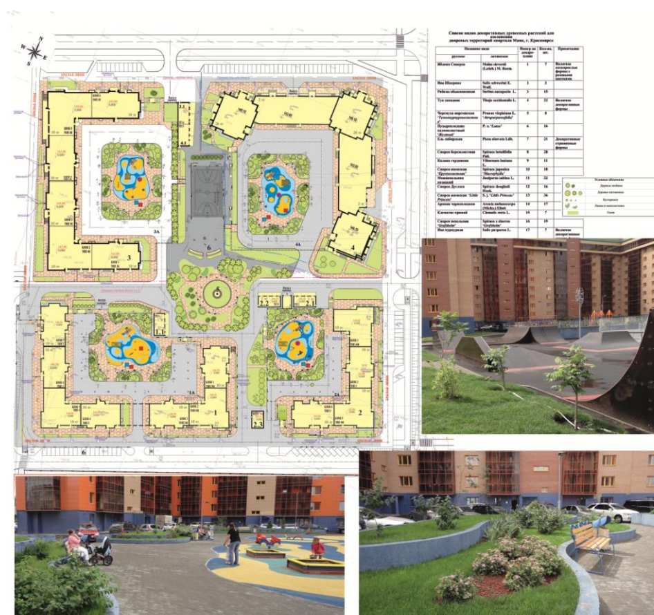
Организация дворового пространства на кровле подземного гаража. Реализация – 2009–2011 гг
