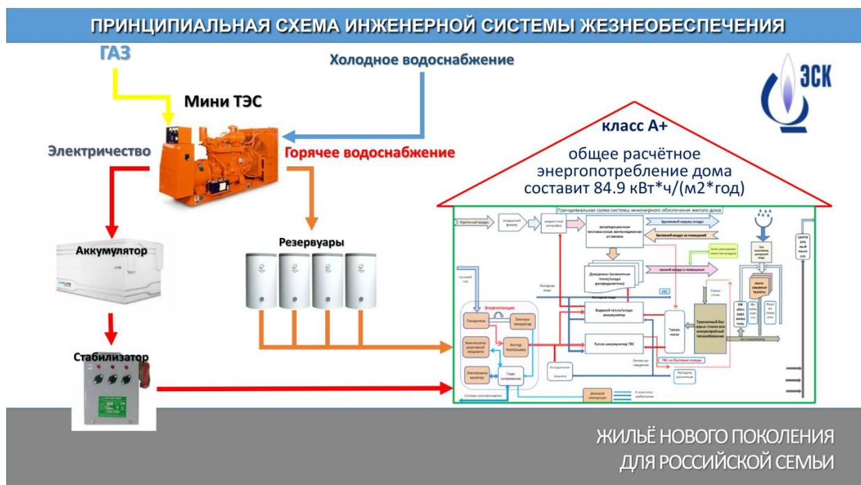
Рис. 1. Принципиальная схема инженерного обеспечения жилого дома
