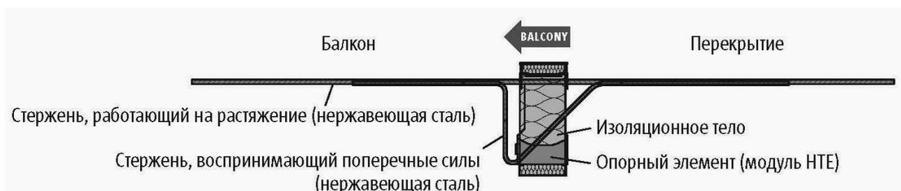
Рисунок 3 - Несущий теплоизоляционный элемент SchöckIsokorb®
