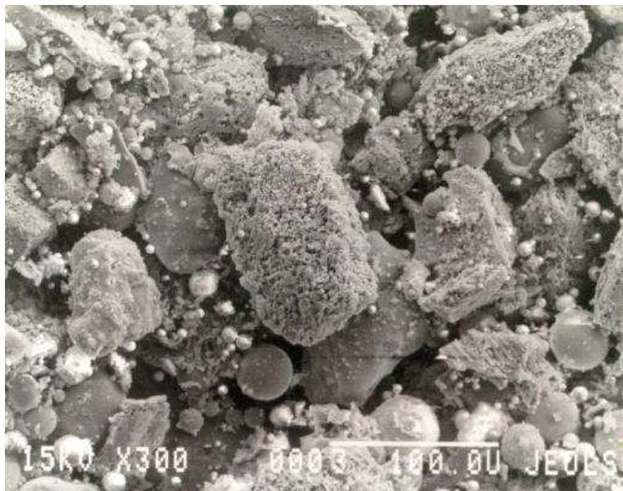
*Рисунок 1- Общий вид частиц золы ТЭС*
