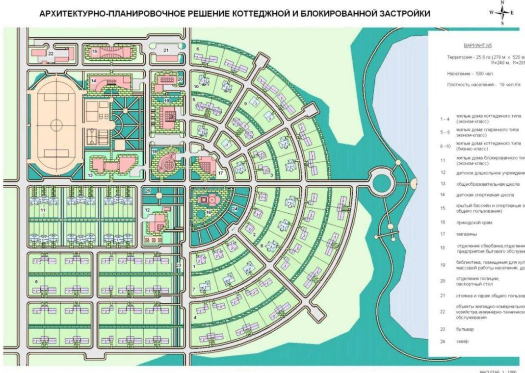
**Рисунок 2 - Эскиз № 2 - архитектурно-планировочное решение блокированной и коттеджной застройки с на 500 человек Квартал с автономными системами энергоснабжения коттеджей и спаренных домов на основе использования газового теплогенератора и ВИЭ; с автономными системами теплоснабжения таунхаусов от мини-ТЭЦ для таунхаусов и как резервой для коттеджей и спаренных домов; смешанным электроснабжением**
