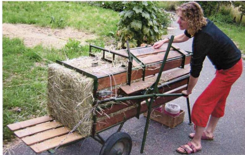
Рисунок 1 – Механизм для формования соломенных блоков
