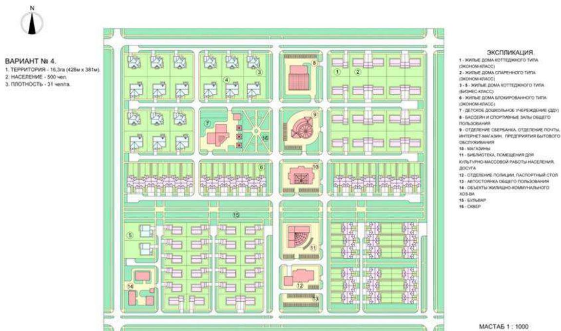
*Рисунок 1- Эскиз № 1-ЖГМ - архитектурно-планировочное решение коттеджной и блокированной застройки на 500 человек. Квартал с автономными системами теплоснабжения коттеджей и спаренных домов на основе использования газового теплогенератора и ВИЭ; с автономными системами теплоснабжения таунхаусов от мини-ТЭЦ; смешанным электроснабжением*
